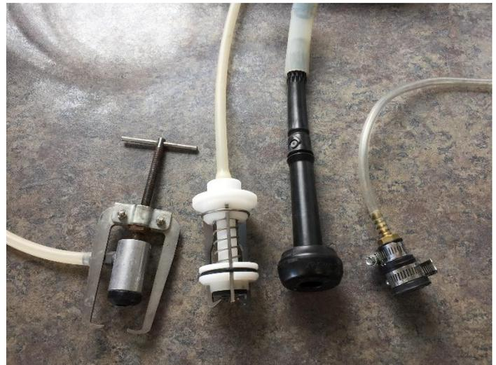
Figura 8. Abrazaderas de las boquillas para cubrir la boquilla y medir la salida de agua. Esta imagen muestra opciones compradas e improvisadas. De izquierda a derecha: Abrazadera AAMS, abrazadera Herbst, abrazadera improvisada hecha de partes de ordeño de vacas y abrazadera improvisada hecha de partes de plomería. Fotografía de Gwen Hoheisel, WSU.
