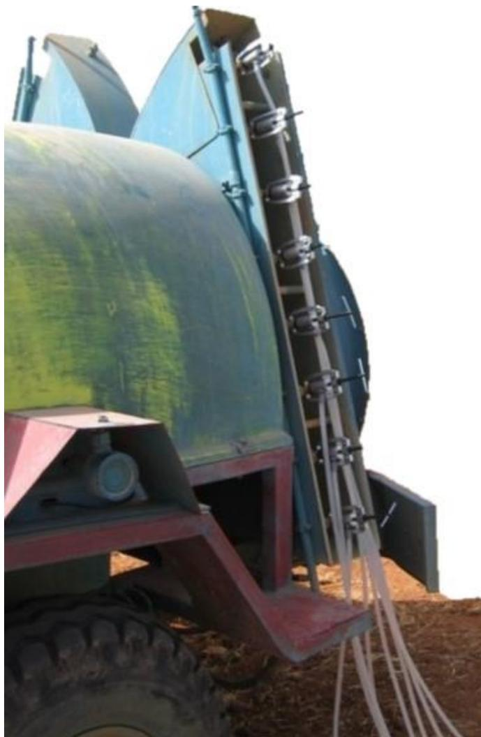
Figura 10. Abrazaderas de boquilla AAMS conectadas a un rociador. La salida se medirá desde cada tubo proveniente de la abrazadera. Fotografía de Gwen Hoheisel, WSU.
