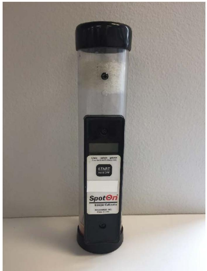
Figura 9. Ejemplo de un medidor de flujo de bajo volumen. Este modelo es preciso para los volúmenes inferiores a 1 GPM, que es adecuado para la mayoría de las selecciones de boquilla. Fotografía de Gwen Hoheisel, WSU.
