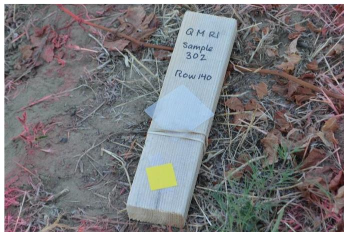
Figura 11. Un pequeño bloque de madera con WSP colocado con cinta en el terreno de una a tres hileras hacia abajo desde el rociador para proporcionar una evaluación visual de la cantidad que se pierde en el terreno. Fotografía por Margaret McCoy, WSU.
